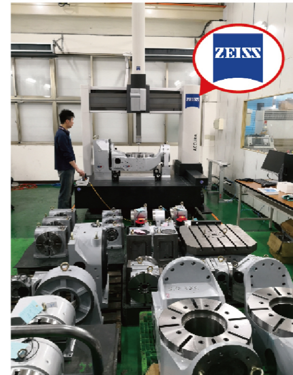
三次元 (三座標) 檢測儀 檢測 幾何精度
